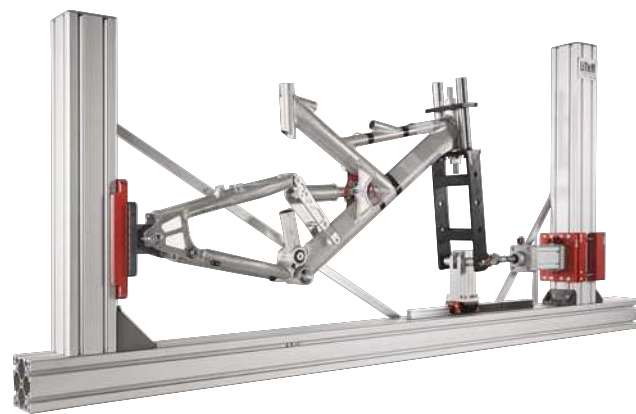
2軸氣動式疲勞試驗 應用例：自行車車架
