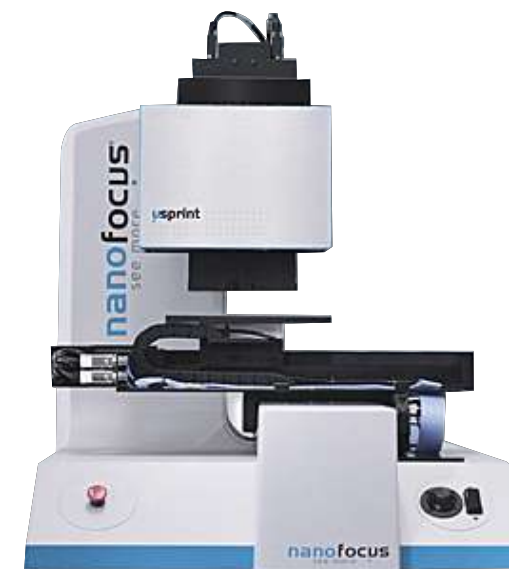
μsprint topographer 高精度的高速3D數據採集
