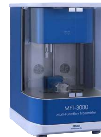
Tribometers 提供單功能和多功能摩擦磨損試驗機，可表徵 摩擦、磨損、粘附、疲勞和多種機械表面特性
