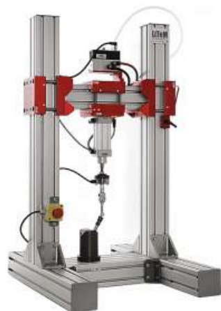
1軸氣動式疲勞試驗 應用例：植牙材料
