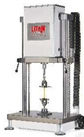
電動式疲勞試驗 (Voice coil 驅動技術)
